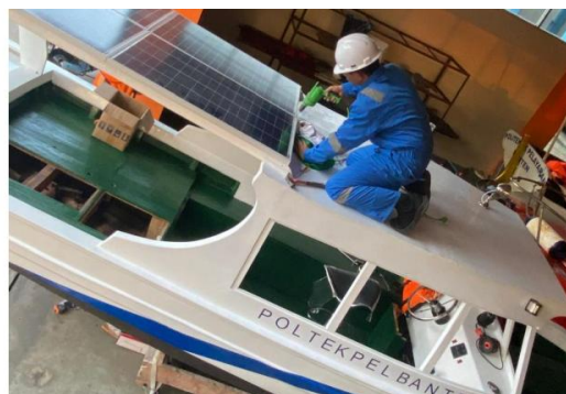
Gambar 2. Pemasangan panel surya.
